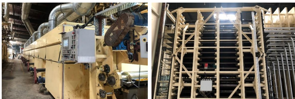
▲ 増設した含浸機(左)とプレス機(右)
