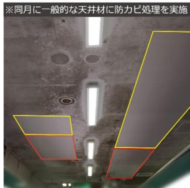
▲経過観察状況(黄枠内:カビテクト基材(未塗装)/赤枠内:カビテクト)
