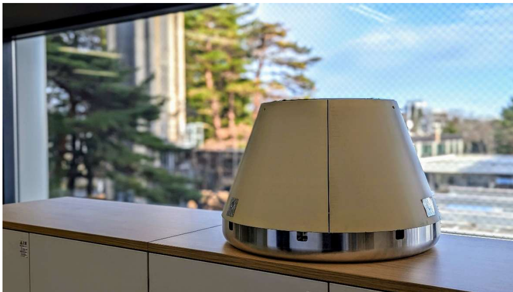
サイドパネル展開試験時に使用した回収カプセル試験用モデル
