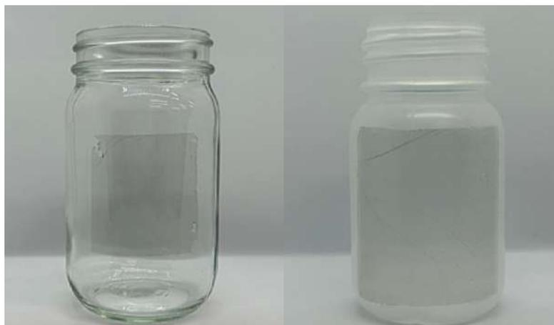
（左）ガラス瓶、（右）ポリエチレンの容器に『CNT 透明導電ナノシート』を転写した様子
