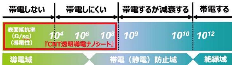
表面抵抗率と帯電のしやすさ (イメージ図)
