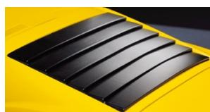
高性能エンジンの熱を排出する6枚ルーバーが、ミウラのリアビューを引き締める。
